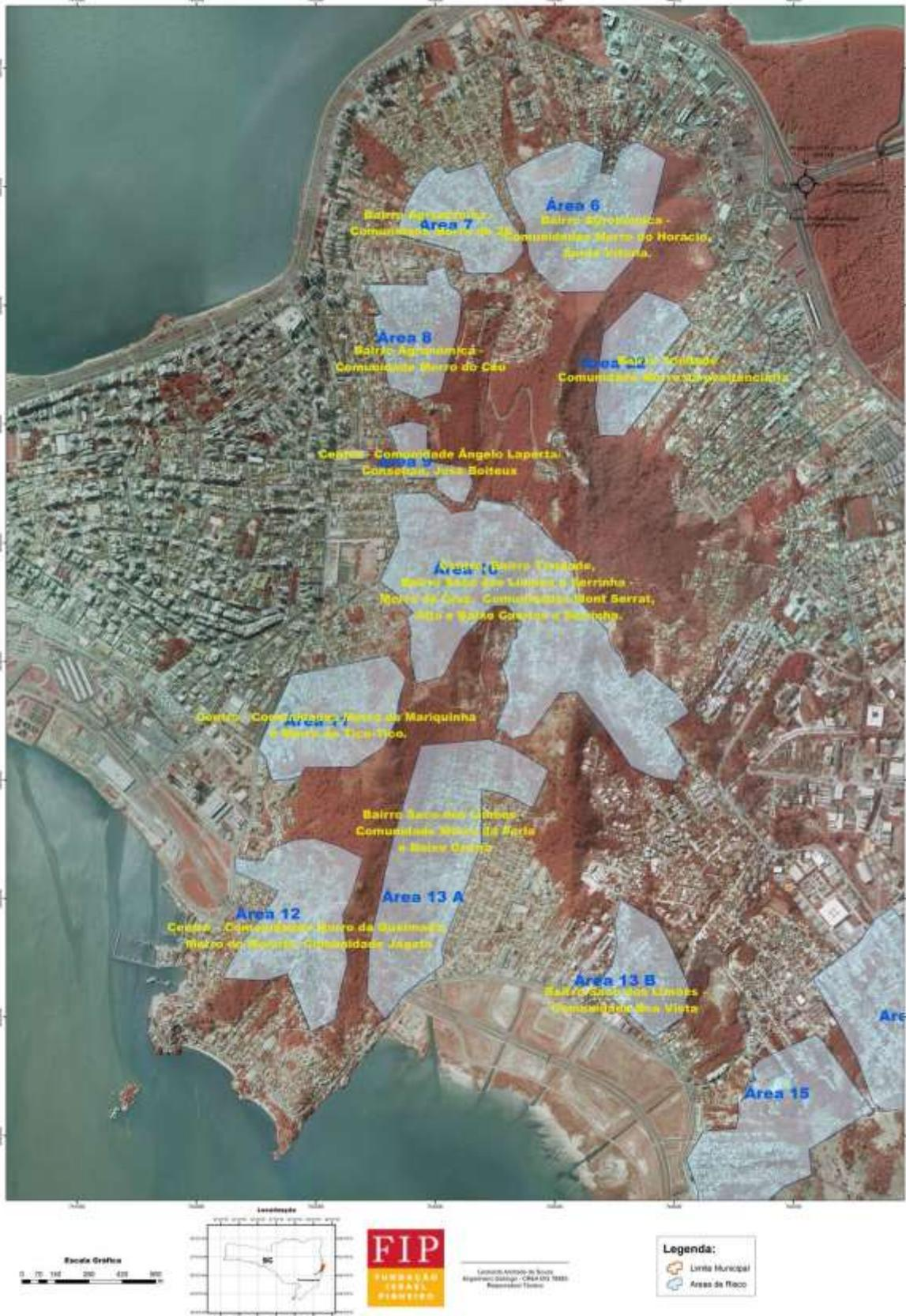
Figura 26 - Área 6, 7, 8, 9, 10, 11, 12, 13A, 13B, 14, 15 e 22 indicadas para a setorização do risco geológico e hidrológico.
