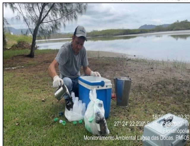
Figura 175. Procedimento de coletas de amostras de água no PM05.
