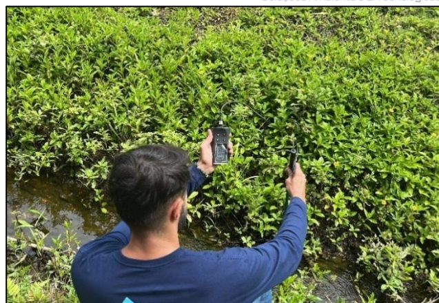
Figura 84. Medições das vazões pontuais no ponto VZ02.
