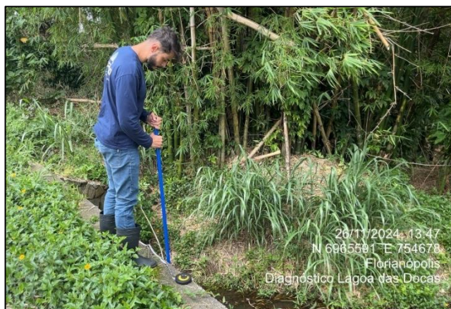
Figura 76. Medições das profundidades da seção de medição.
