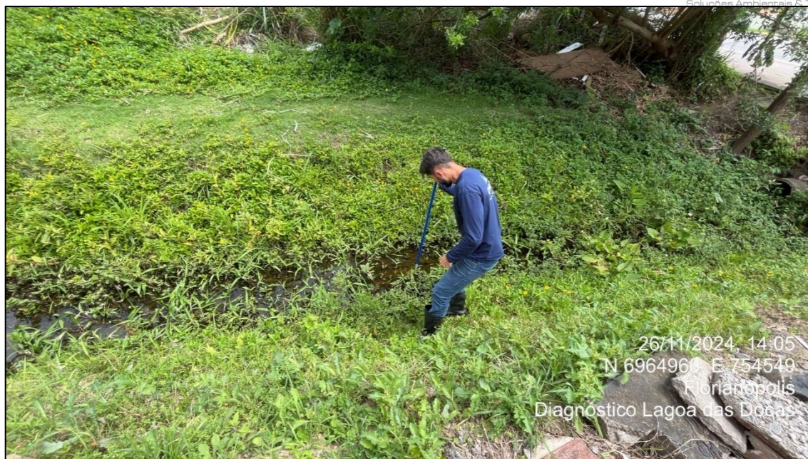
Figura 81. Medições das profundidades do riacho com uso de régua linimétrica.
