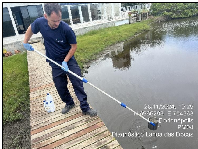
Figura 210. Coletas de amostras de água no PM04 após dias de chuvas.
