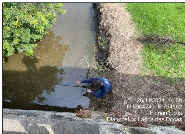
Figura 88. Medições das vazões com uso do molinete.
