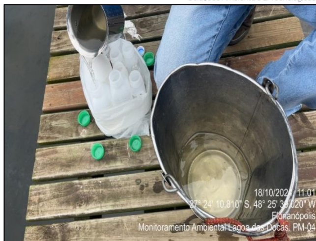
Figura 171. Procedimento de coletas de amostras de água no PM04.
