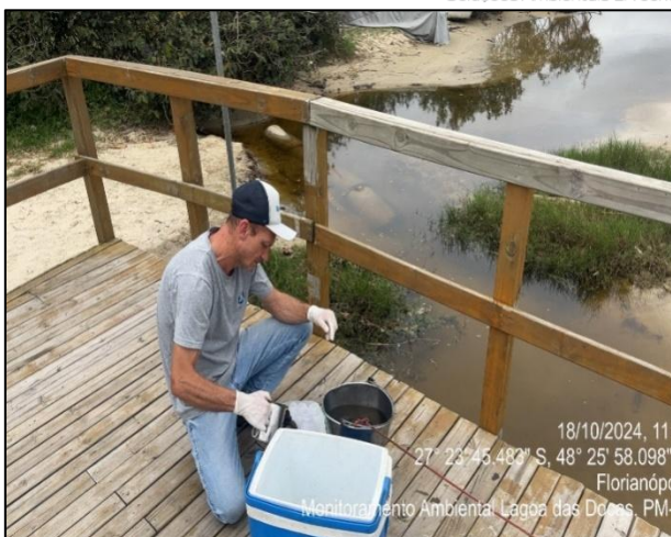
Figura 159. Procedimento de coletas de amostras de água no PM01.
