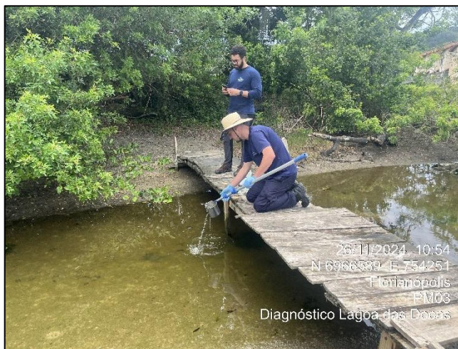
Figura 206. Coletas de amostras de água no PM03 após dias de chuvas.
