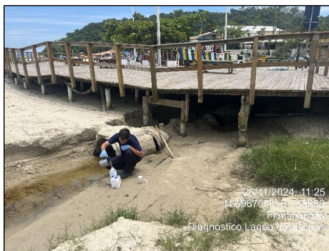
Figura 199. Procedimento de coletas de amostras de água no PM01.
