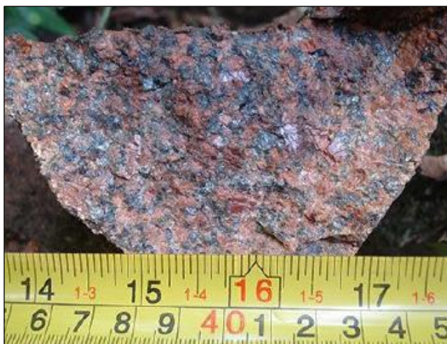
Figura 22. Amostra do Granito Ilha, exibindo coloração rósea e textura equigranular grossa. Fonte: CARDOSO (2017).
