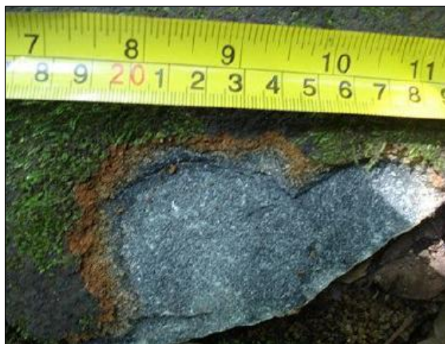
Figura 23. Amostra de diabásio do Enxame de Diques Florianópolis, exibindo textura afanítica a fanerítica fina. Fonte: CARDOSO (2017).
