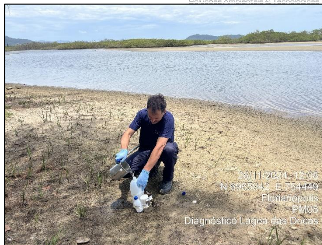
Figura 215. Procedimentos de coleta de amostras de água no PM05.
