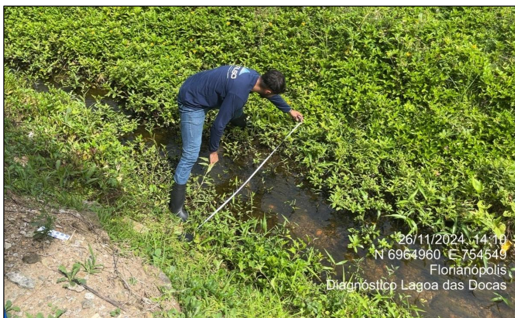
Figura 82. Medição de largura da seção.
