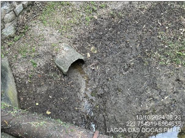
**Figura 7. Possível ponto de lançamento de efluente identificado em inspeção de campo, evidenciando tubulação de drenagem pluvial com escoamento de líquido de aspecto escuro e odor característico de esgoto.**
