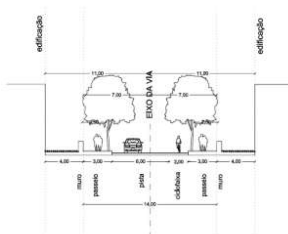
Via 4 – Seção Transversal Planejada (LC nº 482/2014)
