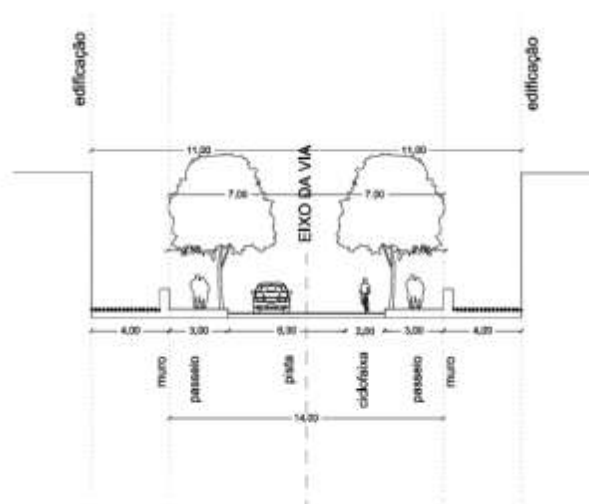
Via 3 – Seção Transversal Planejada (LC nº 482/2014)
