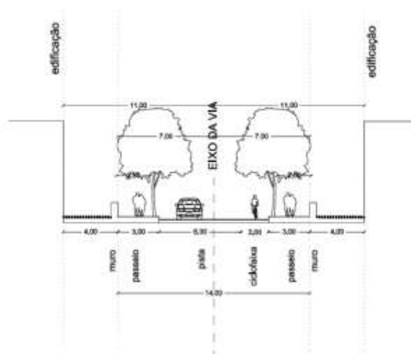
Via 2 – Seção Transversal Planejada (LC nº 482/2014)
