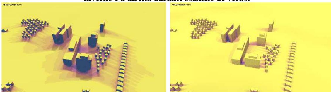
**Figura 13. Incidência de insolação por horas nas fachadas norte e nordeste. À esquerda durante solstício de inverno e à direita durante solstício de verão.**
