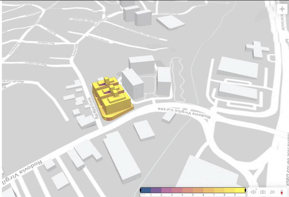
**Figura 28.** Incidência Solar por horas nas fachadas norte e nordeste no Solstício de Verão.
