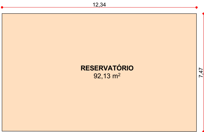
PLANTA BAIXA RESERVATÓRIO ESCALA 1 : 125 ÁREA CONSTRUÍDA = 92,13 m²
