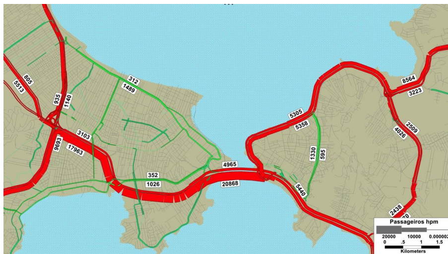
Figura 11-58 - Passageiros no sistema de transporte coletivo, Cenário Orientado com BRT completo, HPM, 2040
