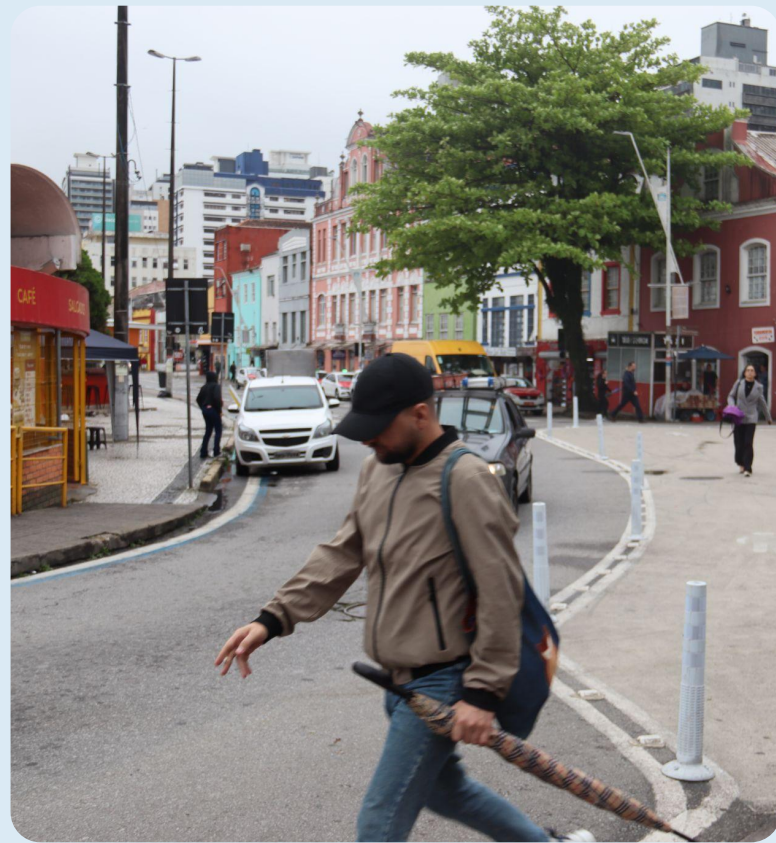
Extensões de calçada com diferenciação de cor e balizadores
