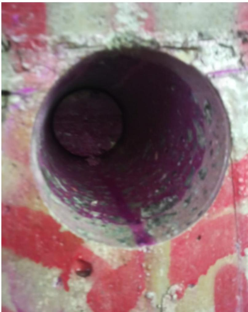
**Foto 012** - Extração do Corpo de Prova - CP02
