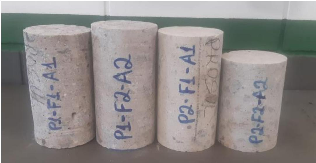
**APÊNDICE B – Fotos dos testemunhos (após o ensaio)**
