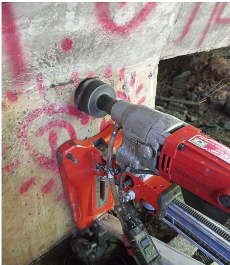
**Foto 011 - Extração do Corpo de Prova - CP01.**
