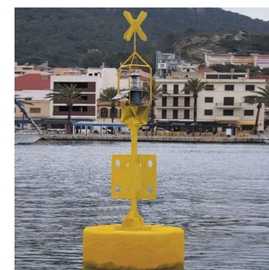
UTILIZAÇÃO DE BOIAS DE BALIZAMENTO DE AREA RESTRITA EM TODA A FAIXA DE PROJETO. A CADA 100 METROS UMA BOIA
