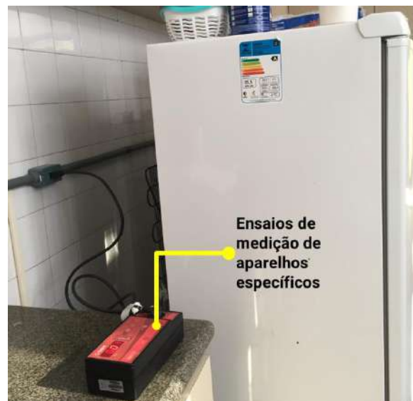
Figura 3 – Levantamento do consumo de refrigeradores e freezers por meio do ensaio de medição utilizando medidor de energia.
