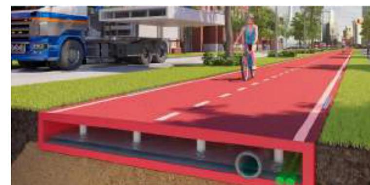
Figura 35: mudanças climáticas e gestão de água: a Plastic Road aborda o problema com seu design inovador de rua oca, que permite o armazenamento temporário de água da chuva e uma drenagem controlada, prevenindo inundações.
