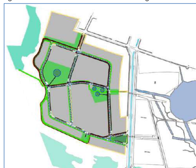
Figura 6: Área 1 - sistema de macrodrenagem verde.
