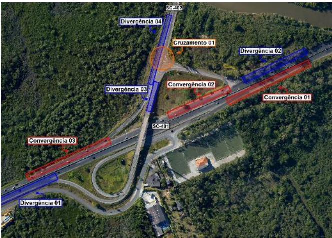
Figura 14: interseção no entroncamento entre a SC-401 e a SC-402
