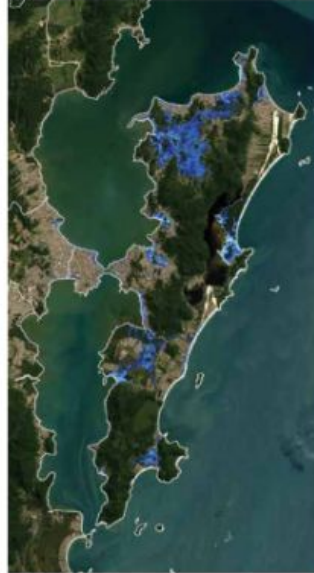
Figura 5.18: Mancha de inundação obtida para os cenários de PR de 200 anos com 1 m de elevação do nível do mar
