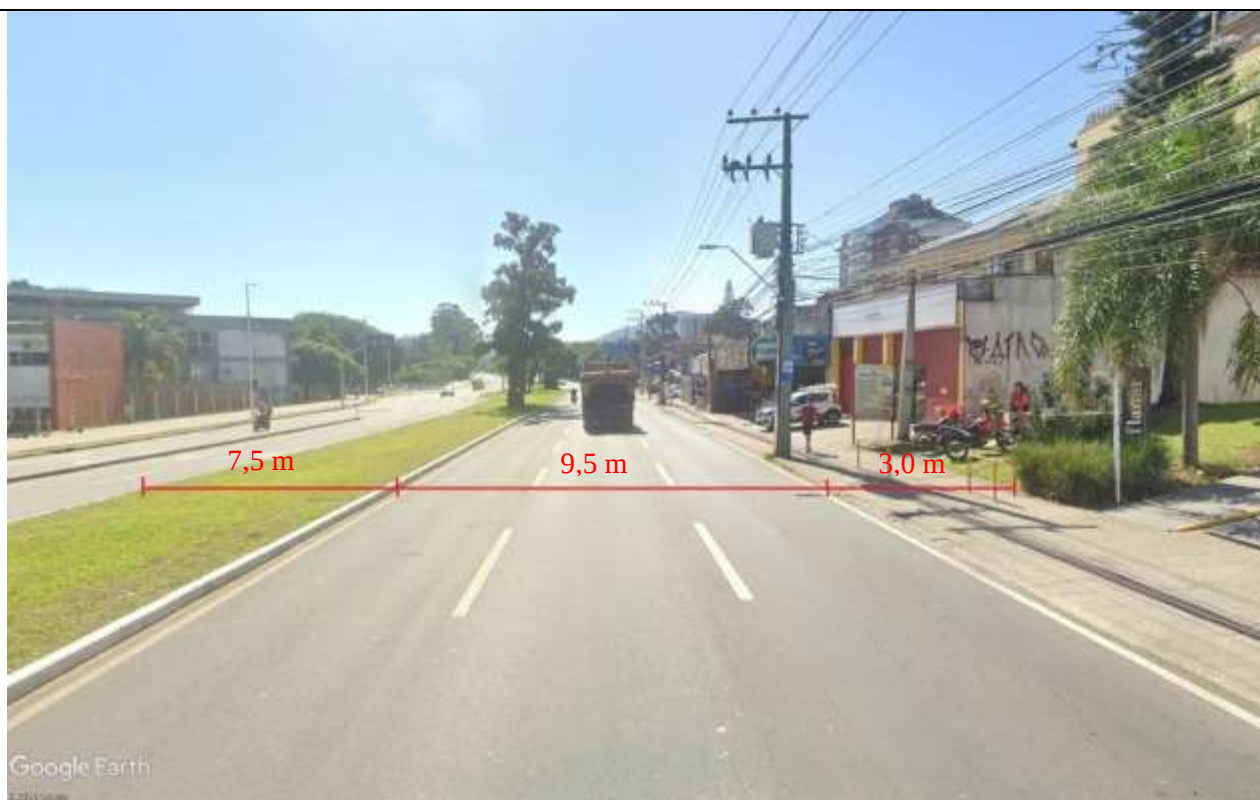
Via 2 – Seção Transversal Planejada (LC nº 482/2014)
