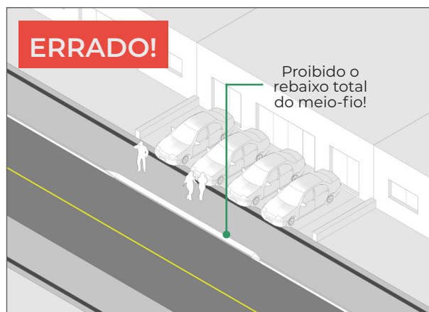
Figura 75: O estacionamento de veículos total ou parcialmente sobre a calçada é irregular.
