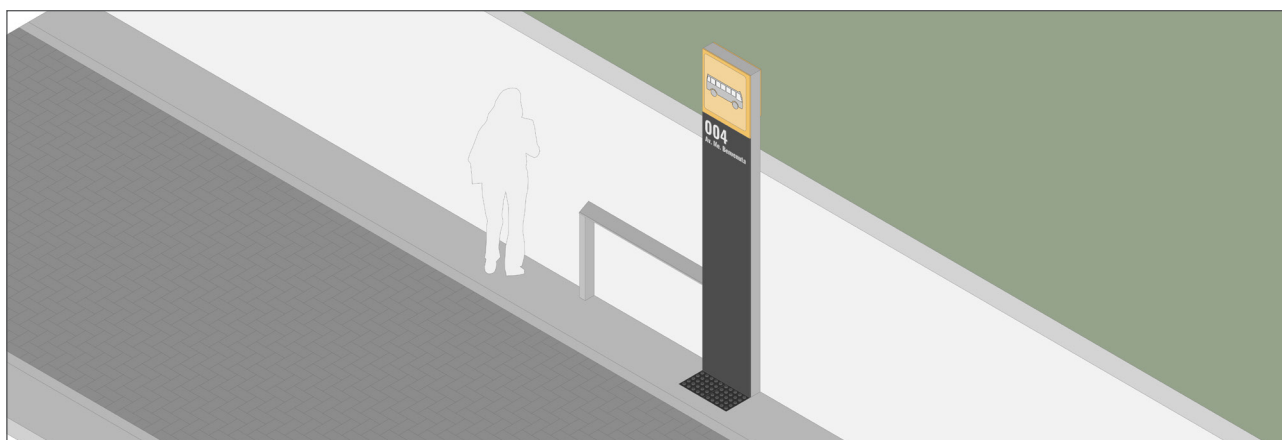
Figura 104: Aplicação de sinalização com piso de alerta para pontos de ônibus em calçadas muito estreitas. Mesmo em situações provisórias, deve-se garantir sinalização tátil mínima e adequada para identificação.
