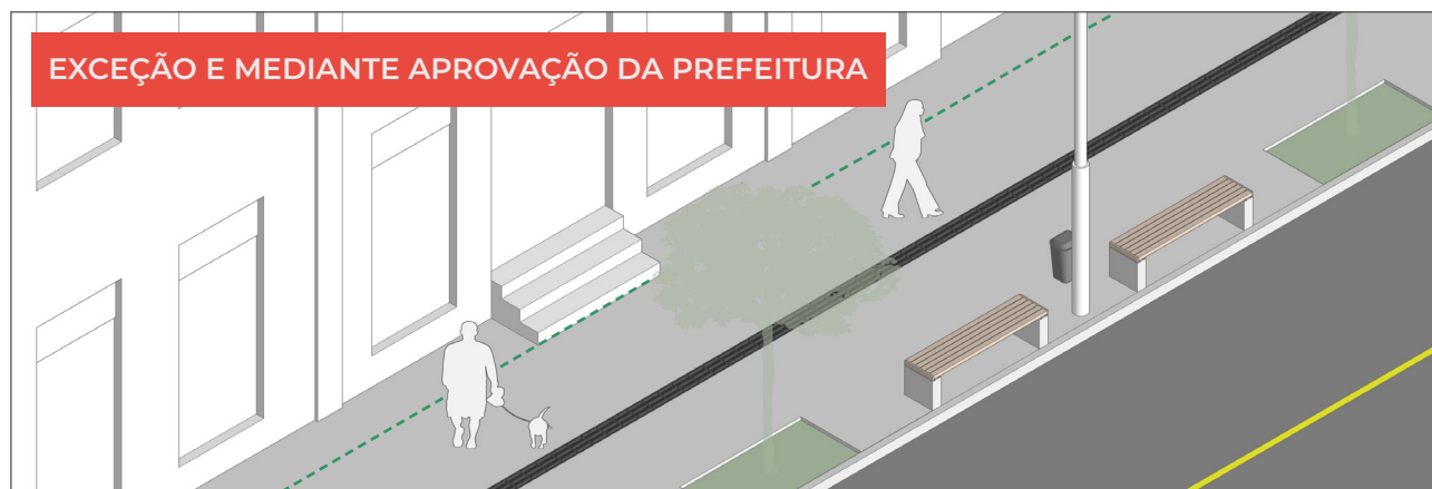
Figura 05: A faixa de acesso é permitida apenas em calçadas com largura superior a 2,00 m, para edificações existentes sem possibilidade de adaptação, mediante aprovação da prefeitura.
