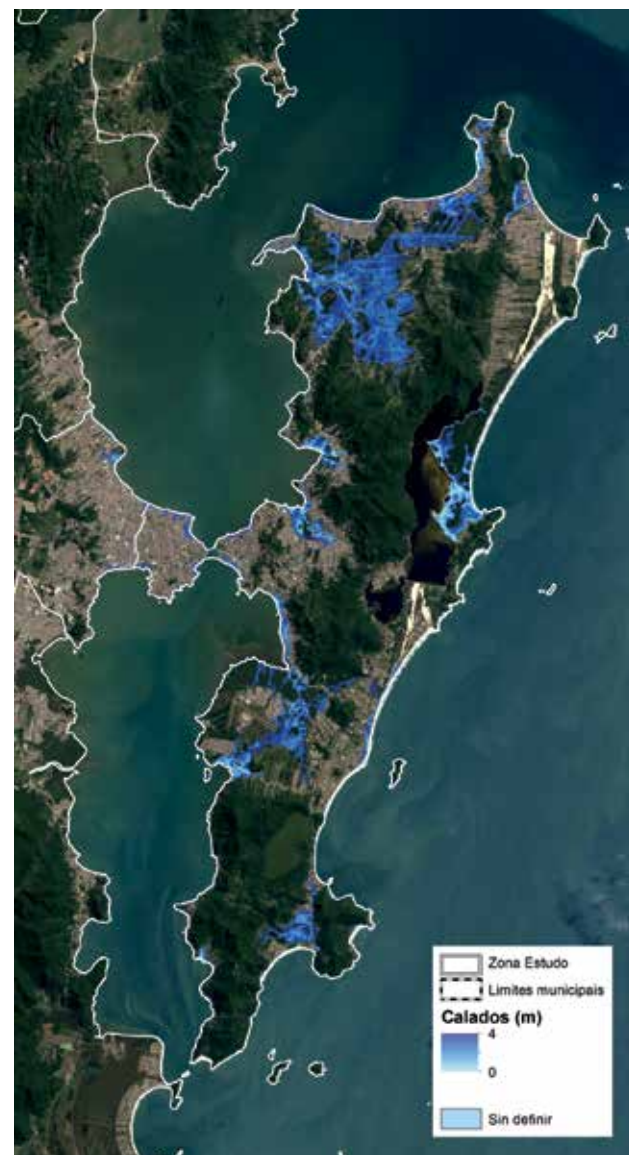
Figura 5: Mancha de inundação obtida para os cenários de período de retorno de 200 anos com 1 m de elevação do nível do mar
